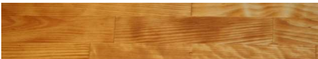
Obrobek z lepených březových kusů, ošetřený olejem.
