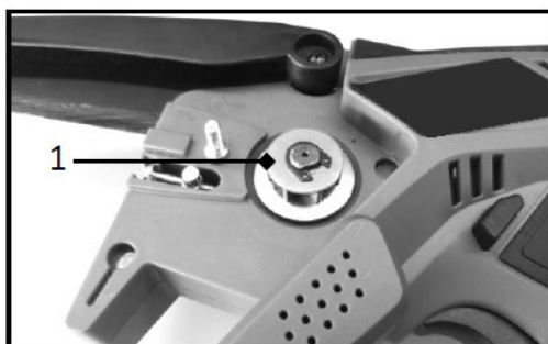
1. Wałek zębaty; 2. Elementy sprawdzone pod kątem zużycia
